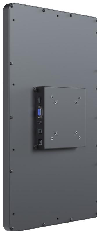
Предназначены для отображения графической или текстовой информации, получаемой по интерфейсам VGA, HDMI, DVI, а также для ввода информации посредством сенсорного экрана.
